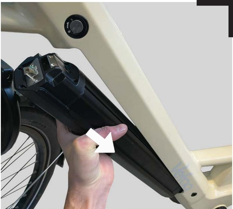
**2** • Rabattez la batterie vers le haut, appuyez fermement pour la verrouiller dans le cadre jusqu'à entendre les deux clics : l'un correspond au levier de fermeture et le deuxième à la sécurité.
