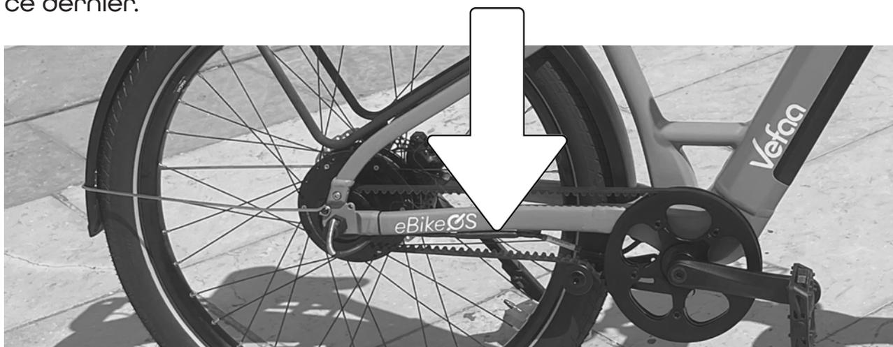
3 - Détendez la courroie, en dévissant le tendeur de courroie, afin de laisser un espace pour pouvoir sortir la roue.
